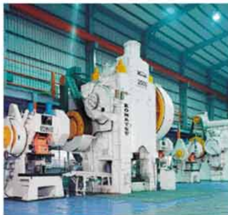
Forging Press 2500 Ton & 1000 Ton Capacity
